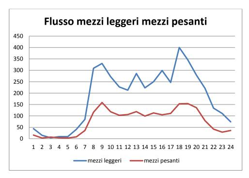
Il flusso dei mezzi pesanti è molto significativo rispetto all'andamento del traffico leggero, caratterizzato da valori anche del 50% dello stesso e da due punte concentrate alle ore 9.00 e le 19.00.
