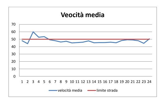
L'andamento della velocità media è distribuito intorno al limite di legge della strada (50 km/h), con superamenti nelle ore notturne in corrispondenza dei momenti di minima del traffico. Solo il 35% di veicoli supera il limite di velocità.
