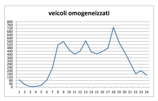
L'andamento è similare a quello registrato nel giorno precedente (medesimo senso di marcia), in cui si osserva il picco concentrato alle ore 18.00 e due punte distinte, di valore inferiore alla precedente e praticamente identiche fra loro, alle ore 9.00 e alle ore 13.00. Il traffico è quasi nullo tra l'1.00 e le 5.00.
