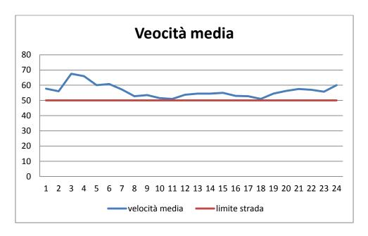
La velocità media si mantiene sempre al di sopra del limite della strada (circa 70% dei veicoli transitanti), con punte nelle ore notturne per via del minor traffico; si notano altresì due diminuzioni in corrispondenza dei picchi di traffico (ore 11.00 e ore 18.00).
