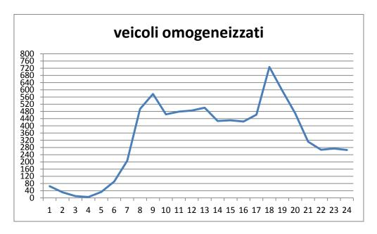
Anche nell'ultimo giorno d'indagine, il picco è concentrato alla sera (alle ore 18.00); si nota altresì una punta di poco inferiore alle ore 9.00 e un'altra alle ore 13.00. Il traffico è scarso nelle ore notturne (tra le 2.00 e le 5.00).
