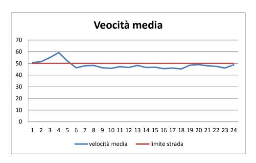
L'andamento della velocità media risulta al di sotto del limite della strada (50 km/h) nell'arco dell'intera giornata, a parte le ore notturne in cu si registrano leggeri superamenti (momenti di minima del traffico); nel complesso circa il 35% dei veicoli supera il limite.
